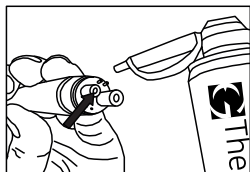
Fig. 8 - Lubrificação Terminal Midwest.
